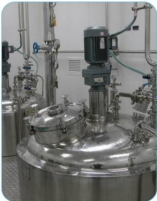
团队自研的**复合陶瓷智能温控反应釜设备**，使得二氧化钛搅拌分散更均匀，**结晶颗粒更小**。
